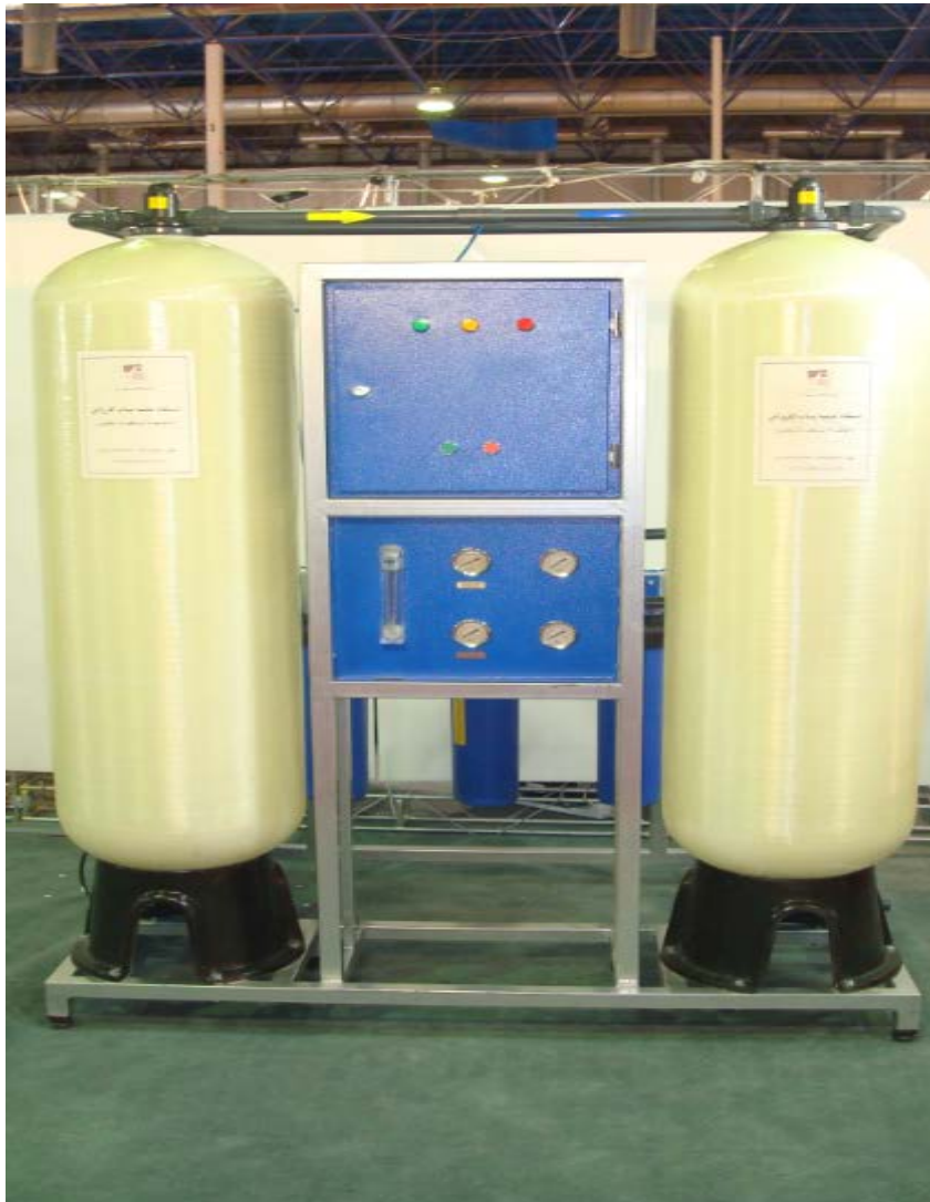
سیستم تصفیه پساب کارواش با ظرفیت ۱۰ مترمکعب در شبانه روز
